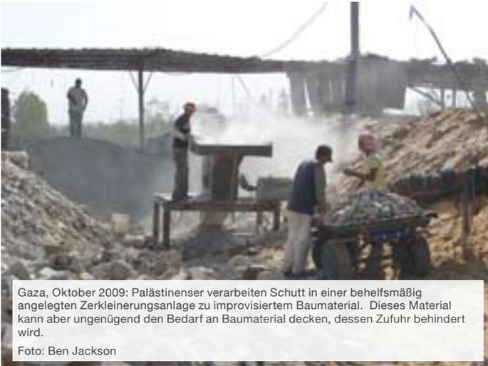
Gaza, Oktober 2009: Palästinenser verarbeiten Schutt in einer behelfsmäßig angelegten Zerkleinerungsanlage zu improvisiertem Baumaterial. Dieses Material kann aber ungenügend den Bedarf an Baumaterial decken, dessen Zufuhr behindert wird.
