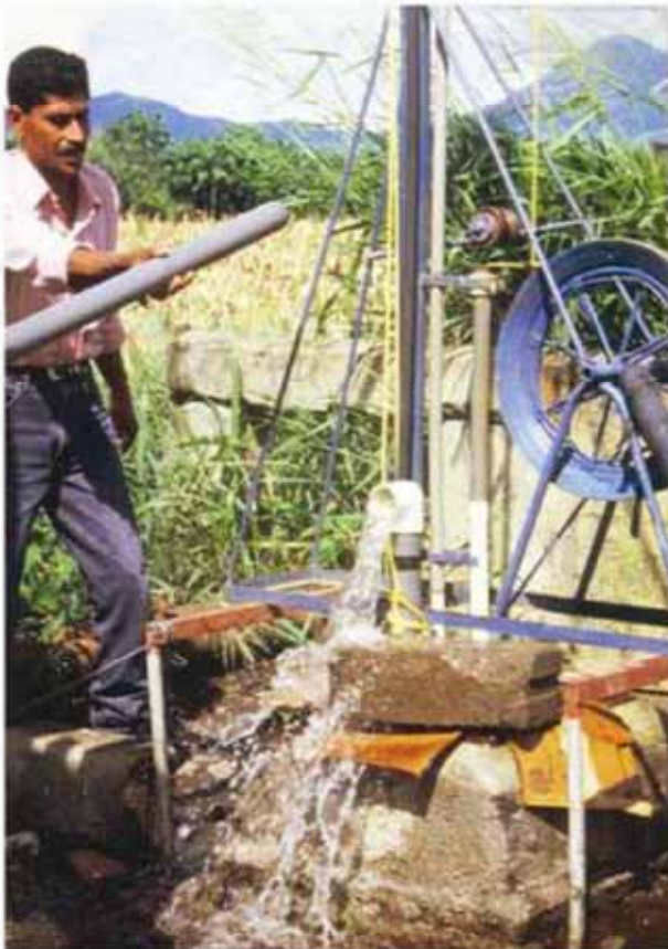
Bomba de mecate, agua potable
